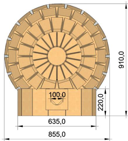
Der Aufbau gelingt dank der **vorgefertigten Kuppelsteine** spielend leicht. Der **helle Haftmörtel** sorgt für eine sehr saubere Verarbeitung und Langlebigkeit – ein Ofen, der bleibt, verbindet und jede Zusammenkunft bereichert.
